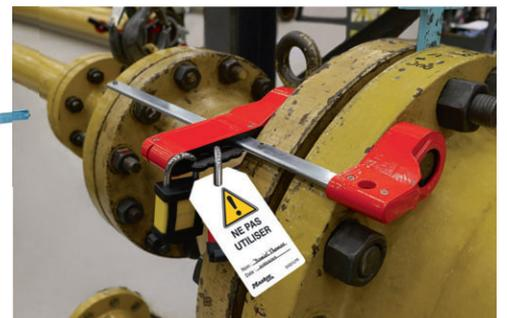
Tous les dispositifs de consignation mécanique peuvent être utilisés avec les cadenas et étiquettes Master Lock
