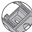
Lorsque "ROCKER" est visible à travers le couvercle, le dispositif de verrouillage est configuré pour un interrupteur à palette.
