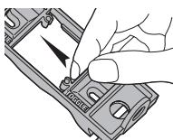
Los deslizadores de doble uso tienen las palabras "TOGGLE" (comutador) y "ROCKER" (basculante) moldeadas en lados opuestos.
