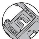
Pour passer de "TOGGLE" (bascule) à "ROCKER" (palette) ou vice versa, appuyer fermement sur la glissière à double fonction pour la déloger de sa base. Retourner la glissière et la replacer par pression. Répéter l'opération pour la deuxième glissière.
