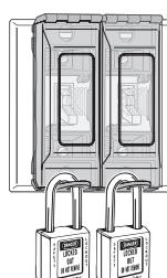
Mueve el interruptor a la posición de encendido o apagado para el mantenimiento necesario. Cierre la tapa, ponga el candado de seguridad.
